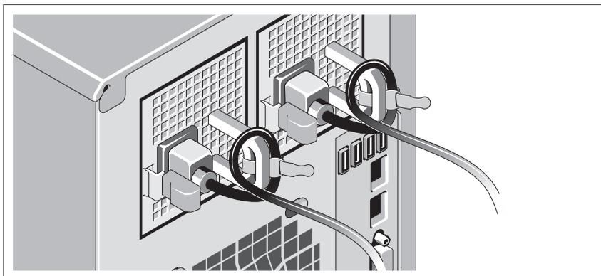
Dobre o(s) cabo(s) de alimentação do sistema em forma de laço conforme apresentado na ilustração e prenda-o(s) com a tira fornecida.
