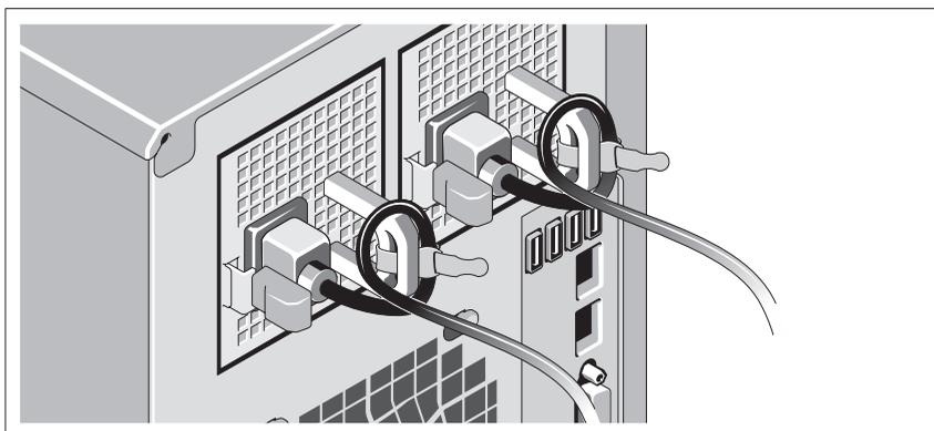
Repliez le ou les câbles d'alimentation système comme indiqué dans l'illustration suivante et fixez-le(s) avec la bande fournie.
