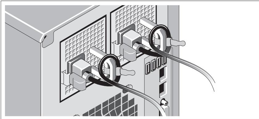
Doble los cables de alimentación del sistema en forma de bucle, como se muestra en la ilustración, y fíjelos con la correa proporcionada.
